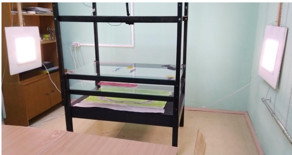
Рис.3.3. Модернизированный мультстол, сверху перемещающаяся крышка со встроенной веб камерой.
